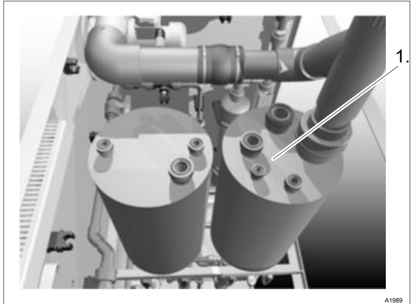
Rys. 66: Wymiana pierścieni uszczelniających po górnej stronie zbiornika ługu (1)
