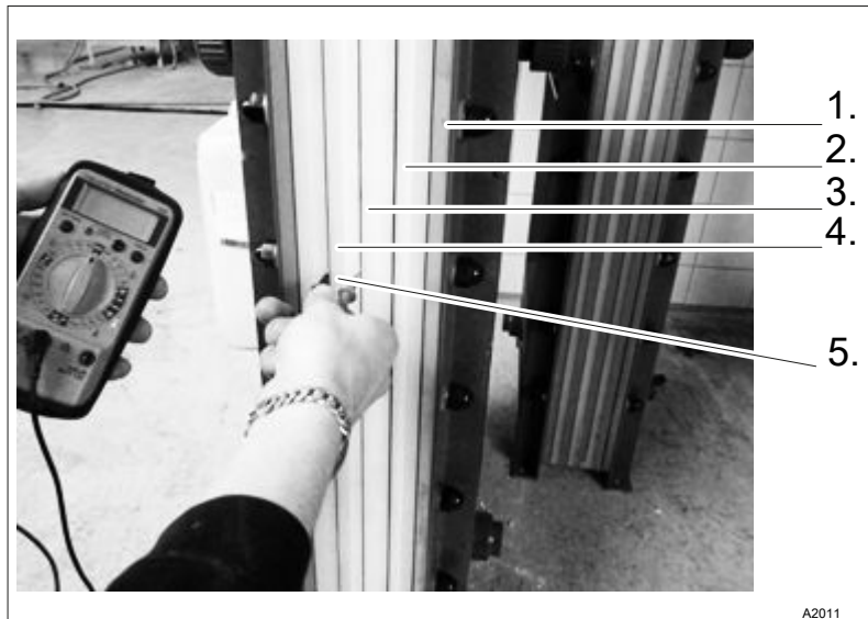
Rys. 31: W tym przykładzie pomiar wykonywany jest przy trzeciej komorze.
